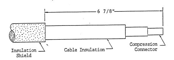
FIGURE I SHIELD STRIPBACK DISTANCE
